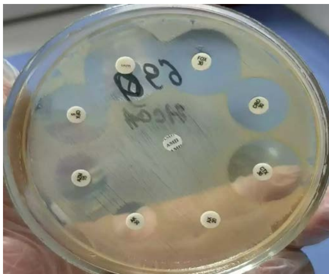
Рисунок 10. – Дискосый метод определения чувствительности микроорганизмов к антибактериальным препаратам
