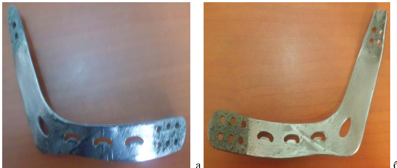
Рисунок 36 – Индивидуально изготовленный эндопротез из никелида титана для замещения ветви, угла и тела нижней челюсти справа: а – наружная поверхность; б – внутренняя поверхность
