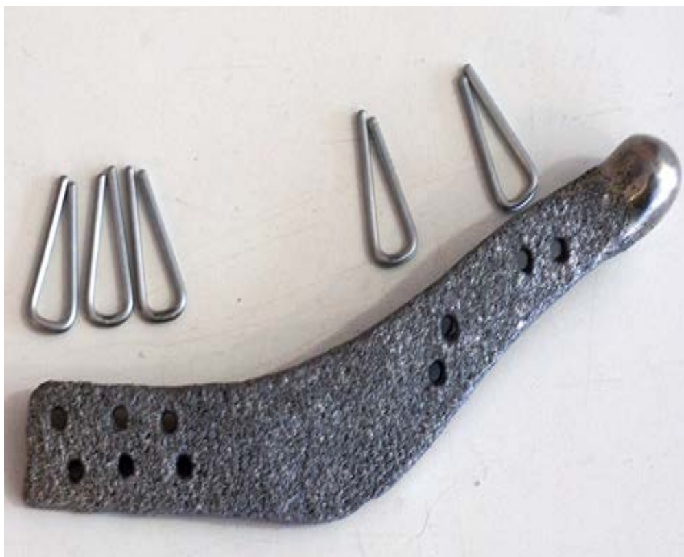
Рисунок 26 – Готовый эндопротез из никелида титана с фиксирующими элементами
