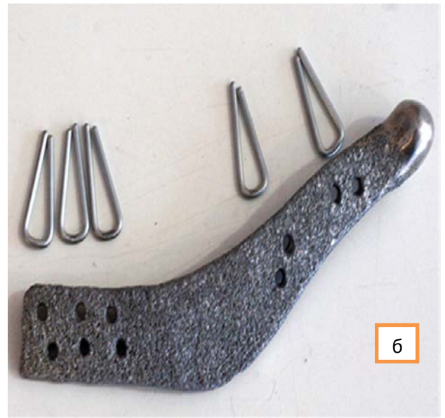
Рисунок 70 – а - стереолитографическая модель челюсти (указана линия резекции). б - готовый эндопротез из никелида титана с фиксирующими элементами
