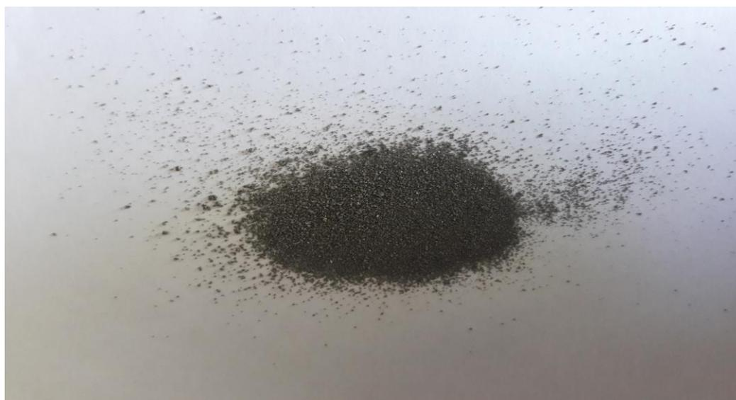
*Рис.5. Мелкодисперсный пористо-проницаемый никелида титан.*
