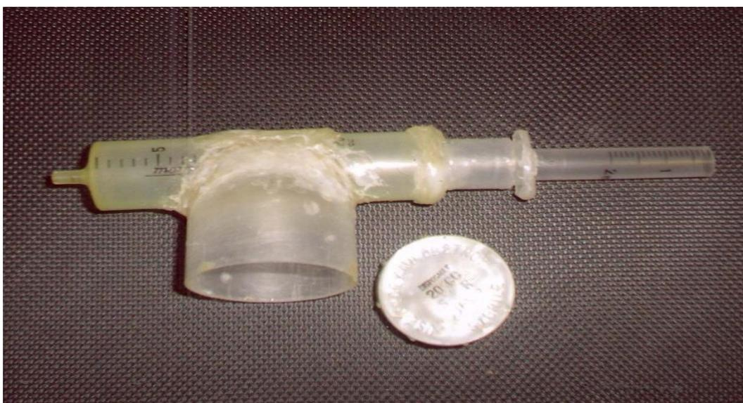
Рис.21. Устройство для введения мелкодисперсных гранул никелида титана.
